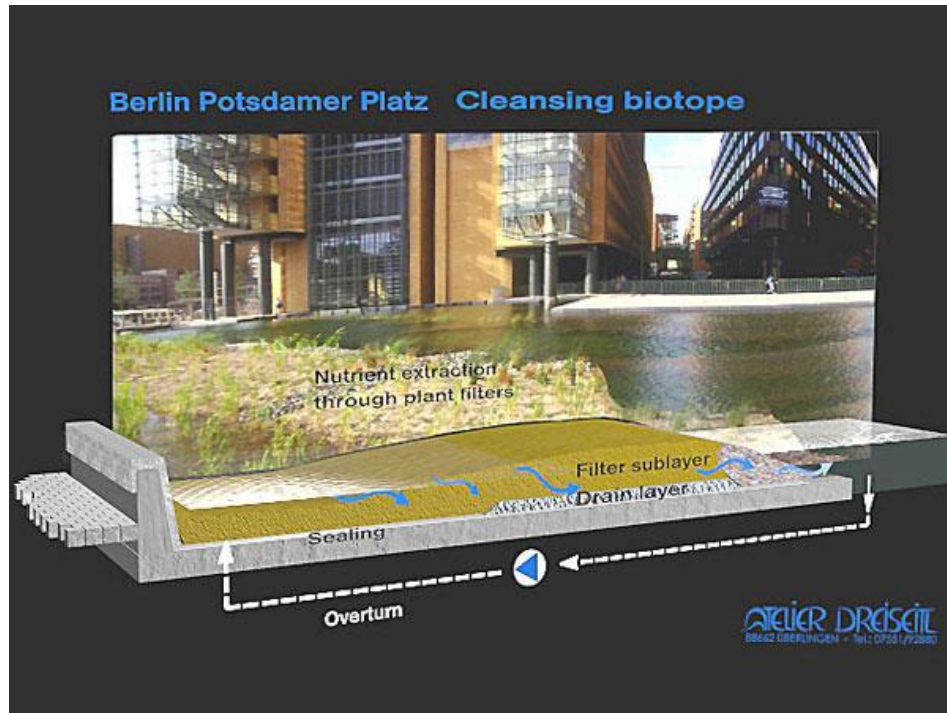
Figure 35: Bioslopes in Potsdamer Platz (courtesy of Atelier Dreiseitl)
